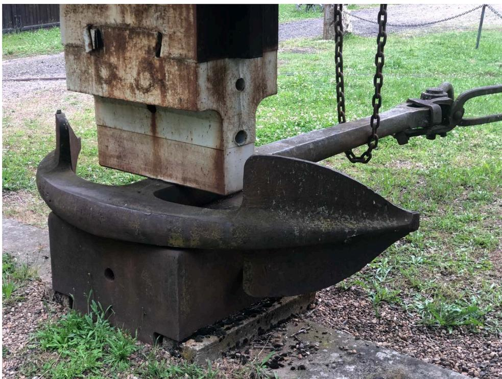
Ce marteau pilon est accompagné d'une grue à bras. Initialement mis en mouvement par la vapeur, il a été modifié au moment d'adopter l'air comprimé pour la force motrice. Les Forges Royales accueillent plusieurs marteaux pilons de différents modèles, placés devant le Musée Forges et Marines.
