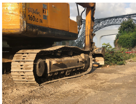
Train de roulement d'un engin chenillé de travaux publics. Le Barbotin se trouve à l'arrière de ce train, très proche de celui des Caterpillar Holt Baby du début du XX e siècle. Au fond, le pont Eiffel de Porto. Photo auteur.
