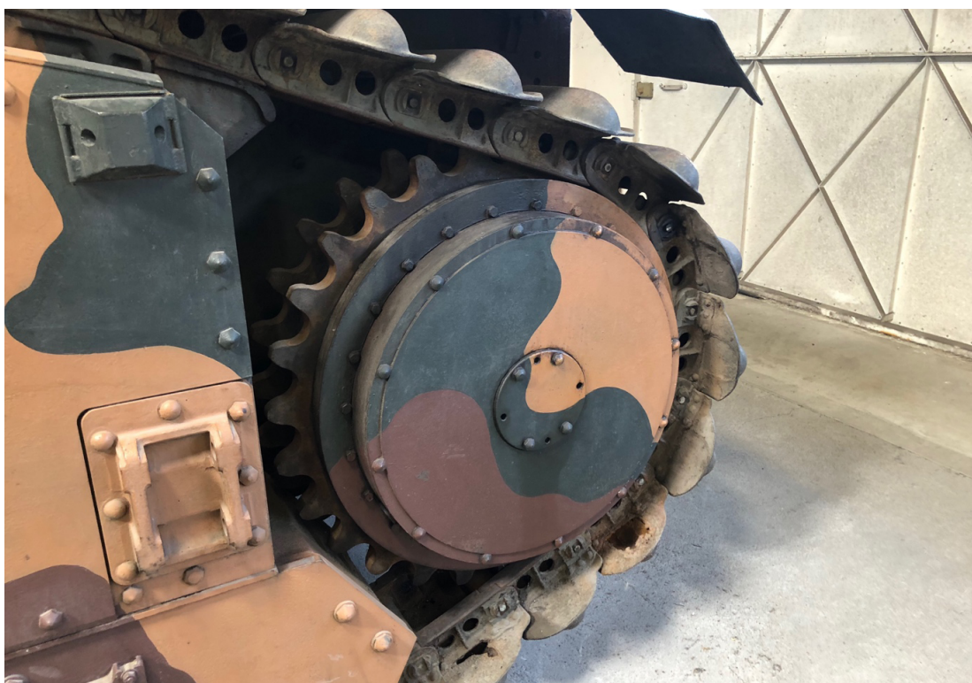
Barbotin double situé à l'arrière du train de roulement du char français B1 bis, considéré comme un des meilleurs blindés au monde en 1940. Musée des blindés de Saumur, photo auteur.
