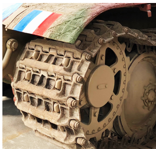
Chenille, Barbotin et galet d'un Panzer V Panther allemand, capturé et utilisé par les armées françaises. Exemplaire conservé au musée des blindés de Saumur. Photo auteur.
