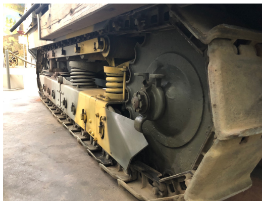
Train de roulement gauche d'un char Schneider CA1 avec, au premier plan, son Barbotin. Engin conservé au musée des Blindés de Saumur. Photo auteur.
