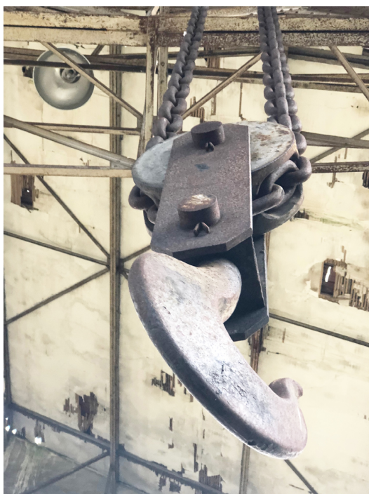
Barbotin et crochet d'un engin de levage encore visible au sein du bâtiment du puits Henri-Paul, inauguré en 1927, à La Machine, Nièvre. Photo auteur.
